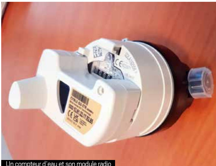
Un compteur d'eau et son module radio
